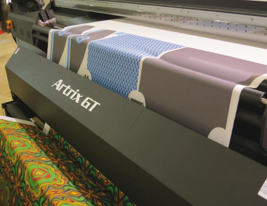
На стенде «НИССА-дистрибуция»: промышленный текстильный принтер «dGen Artrix GT» по тканям с классической системой проводки ткани (на «кирзе»)
