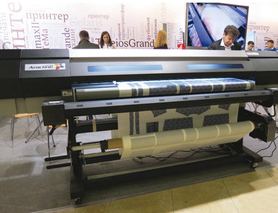
На стенде «НИССА-дистрибуция»: широкоформатный текстильный принтер «dGen Arachne 74 Combo» с цилиндровой системой проводки ткани
