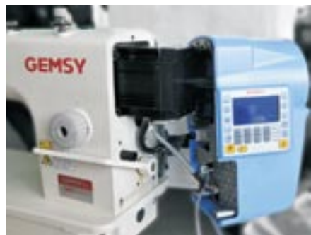
Рис. 1. Интегрированный с корпусом блок управления машиной: двигатель, пульт и платы управления
