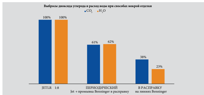
Рис. 3. Сравнение выбросов диоксида углерода и потребления воды. ВЛТ — мокрая отделка врасpravку
