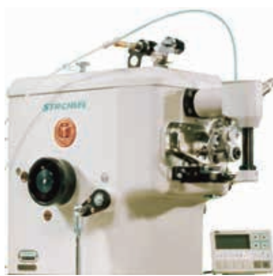
Рис. 4. Машина класса 141–1 EV KEVLAR для соединения стельки из многослойного кевлара с верхом обуви.
