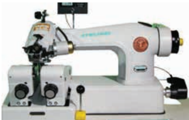
Рис. 1. Машина класса 124–14 D с вертикальным проходом подшиваемого края.
