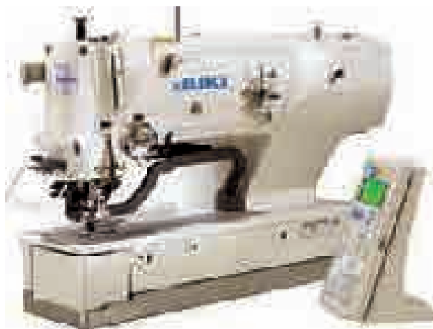
Полуавтомат фирмы JUKI класс LBN-1790A с пультом управления серии MC 600.
