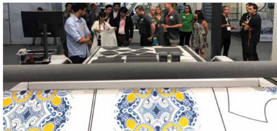
Раскрой материала в рулоне с системой размотки колыбельного типа, идеально для работы с эластичными тканями
